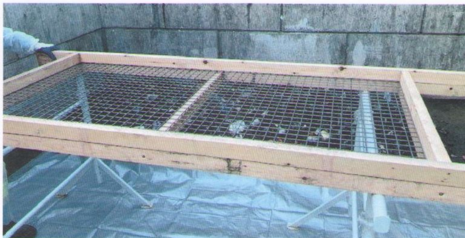
Obr. 3: Síto pro prosívání odpadu (oka 40 mm)
